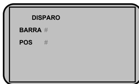
Se visualizará junto a **BARRA** la barra disparada (por fallo de interruptor, unidad diferencial o activación de entrada digital). Junto a **POS** se indicarán las posiciones disparadas. En el caso de que los disparos estuvieran repuestos el mensaje que se leería en pantalla sería el siguiente: **DISPARO REPUESTO**.
