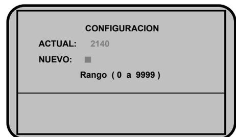
En la primera fila de cada pantalla se identifica la opción de ajuste seleccionada. En la segunda el valor de ajuste operativo. En la tercera, en el lugar indicado por el cursor intermitente, se puede editar un nuevo ajuste. En la última fila se especifica el rango para el ajuste.
