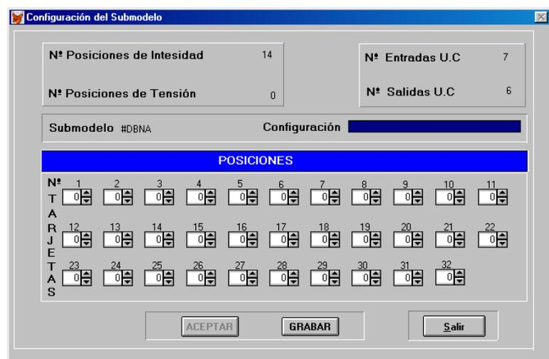
Es necesario ajustar correctamente el número de tarjetas de cada posición, ya que en el modo emulación sólo se tiene posibilidad de añadir a la lista de ajustes las entradas y salidas de las posiciones en las tarjetas que se han indicado en la configuración.
